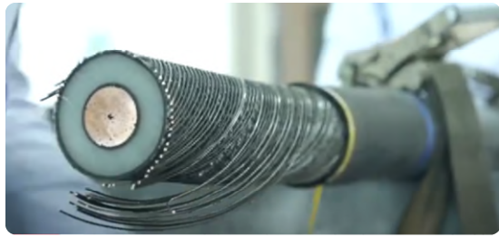
剝除後露出遮蔽銅線
